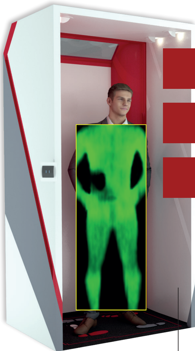
Terahertzbild des LPCs mit verstecktem Gegenstand
